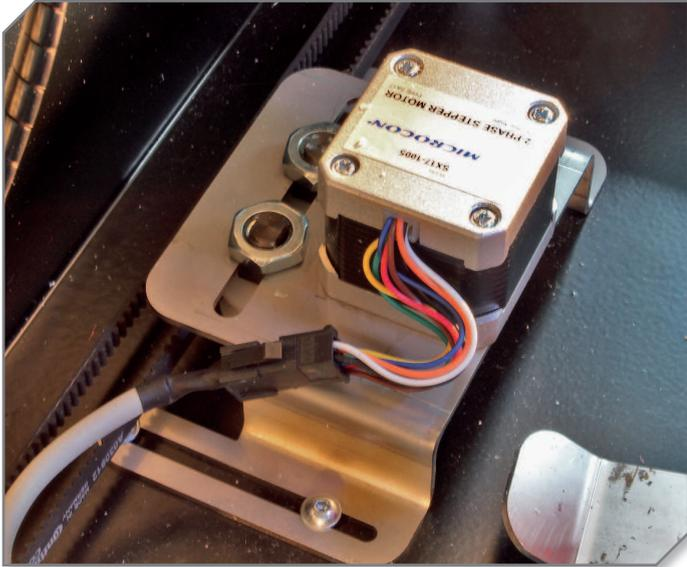
Der Schrittmotor des Z-Achsen-Antriebs wirkt über einen Zahnriemen auf die beiden Trapezgewindespindeln
