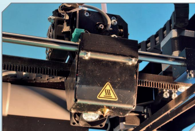
Blick von unten auf den Extruderkopf, dahinter leicht verdeckt zu sehen der kleine Lüfter für eine optionale Kühlung des Werkstücks
